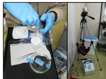
写真2 相補型のろ過捕集状況 (アクリルアミド)
