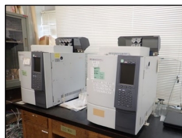
写真4 ガスクロマトグラフ
