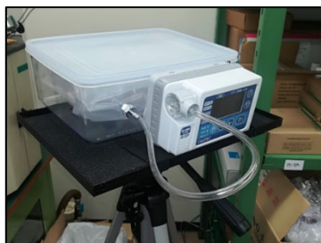
写真1 テドラバックへの直接捕集状況
